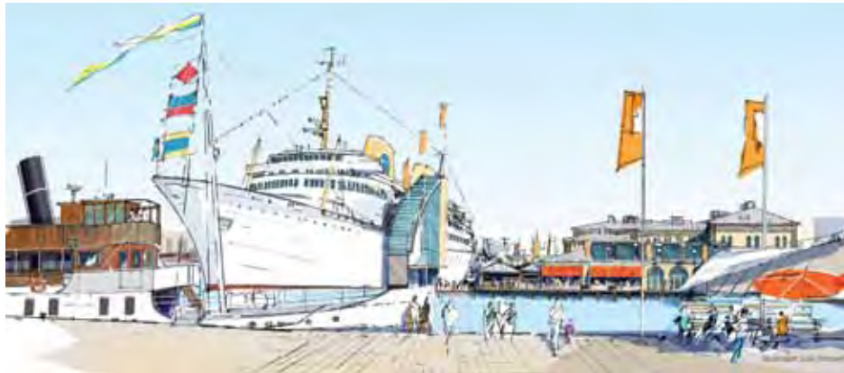
MS KUNGSBOLM. Byggt 1965 av John Brown & Co Ltd, Clydebank, Skottland. Varusnummer: 728. Dimensioner: 207,33 x 26,57 x 8,56 m. Br/ Nv/ Dwt: 26677/ 12820/ 4984. Efter ombyggnad: Br: 27670. Maskiner: Tui Göteborgen V6-9V diesel. Effekt: 18536 kW. Knop: 21,0. Passagerare: 712. Hypplöstar: 712.
